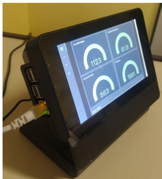
Slika 8: Terminal za sprotni prikaz stanja procesa
